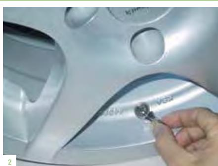
Adapter auf das Ventil aufschrauben und befüllen.
